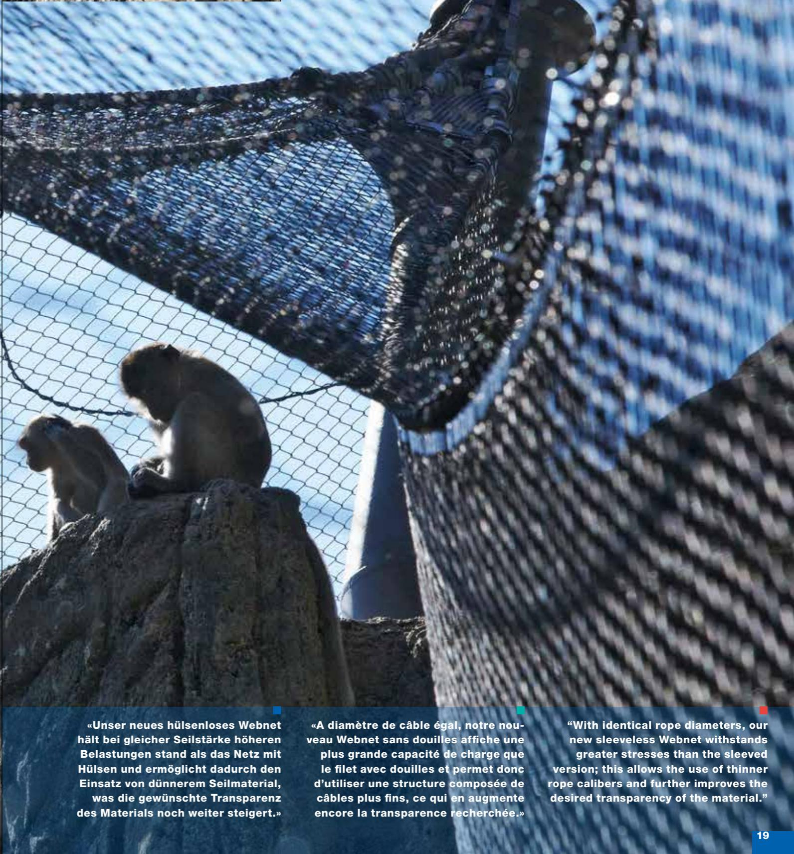
“Unser neues hülsenloses Webnet hält bei gleicher Seilstärke höheren Belastungen stand als das Netz mit Hülsen und ermöglicht dadurch den Einsatz von dünnerem Seilmaterial, was die gewünschte Transparenz des Materials noch weiter steigert.”
